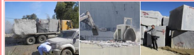
G654長泰(グレー御影石)の丁場。平成29年12月31日で閉山予定の為、最後の採掘ラッシュの真っ最中。岩盤を大きな刃で切って割出す。原石は1個約5～8トン程。過酷な山道を運搬するトラックは過積載でタイヤが蒸気を揚げています。(P4に関連記事)
