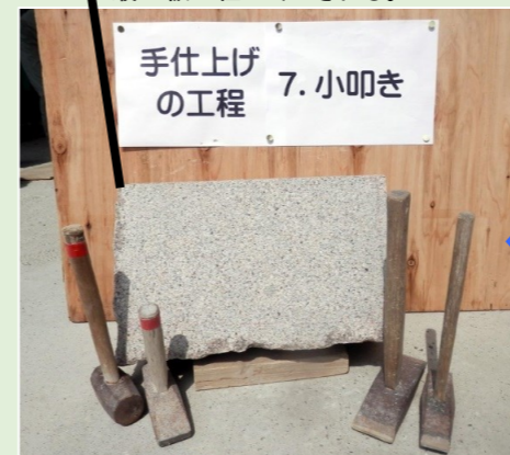
ビシャン仕上げの面を「片刃・両刃」と言う道具で一方に細かく叩き、叩き目を揃えて仕上げる。「小叩き仕上げ」
