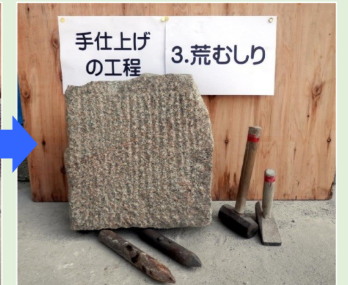
荒切りした溝の底に合わせて山になっている部分をノミで荒くむしる。
