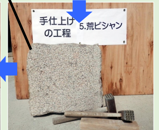
コブの付いた鍬(ビシャン)で叩き、表面を平らに整える。荒ビシャンは刃が4×4や5×5の物。「荒ビシャン仕上げ」
