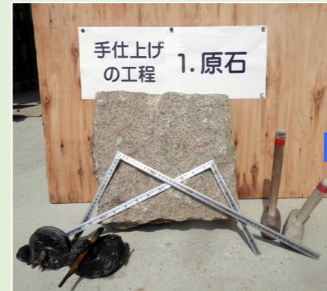
加工されていない原石の状態。ここからどの様な加工をするのか決めて寸法を出し、墨掛けをする。この状態も「割肌仕上げ」と言う仕上げで使用される事もある。
