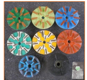
【齋藤繁樹】 ↑現代の石材研磨用砥石。粒度によって素材と形状が違っている。
