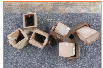
↑「角砥石」を3つ固定し、モーターで回して研磨していた時代の工具。
