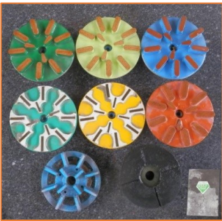
↑現代の石材研磨用砥石。粒度によって素材と形状が違っている。
