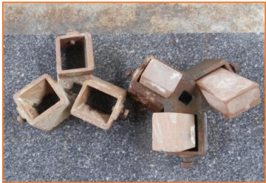
↑「角砥石」を3つ固定し、モーターで回して研磨していた時代の工具。
